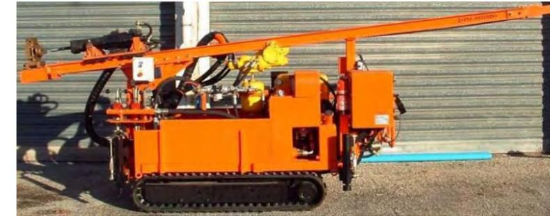
Photo 61 : Sonduse de type wagon drill hydraulique (Source : FONDASOL)
