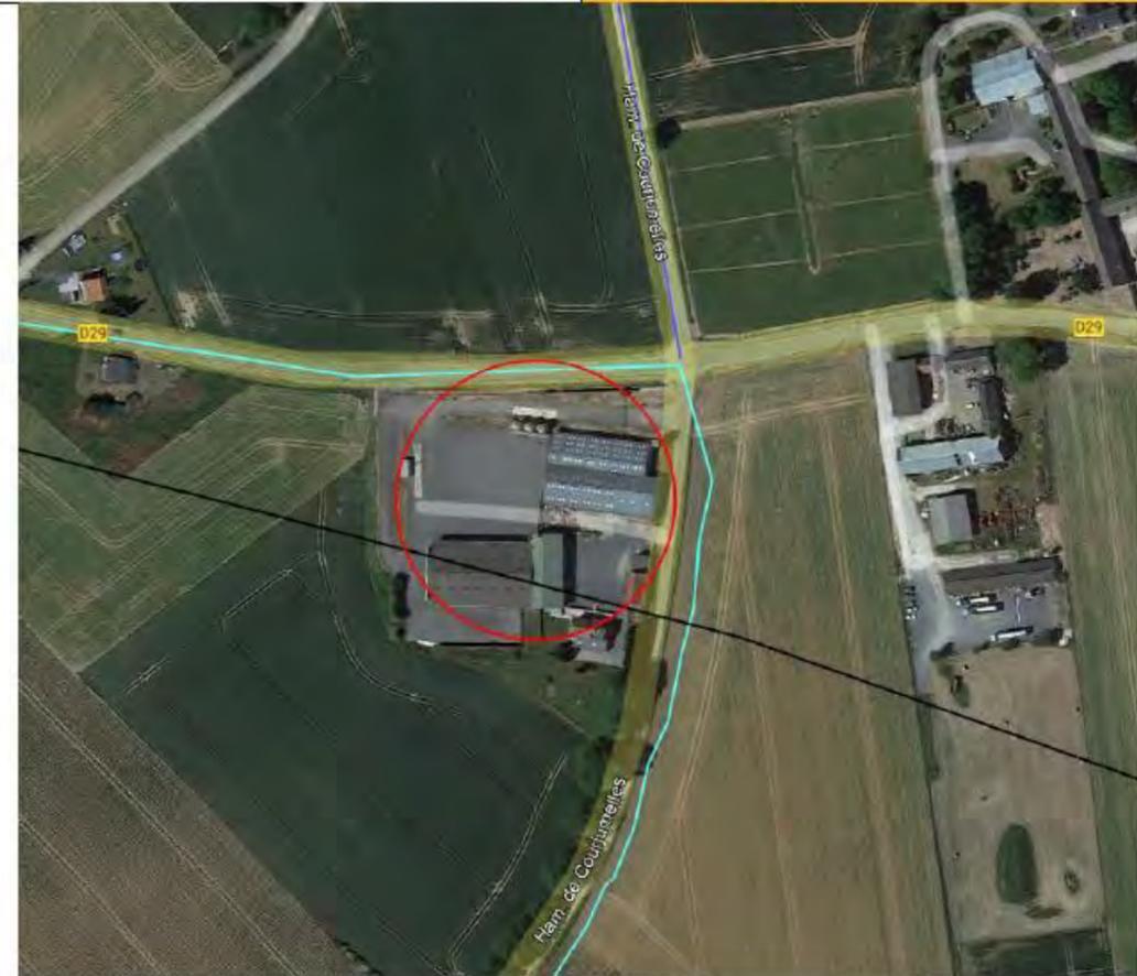
Création du rayon de courbure nécessaire avec potentiel aménagement dans le champ. Cependant la voirie permet la création d'un virage qui semble permettre d'éviter d'impacter le champ à l'est de D69.
